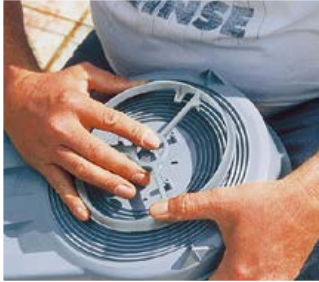
Enclencher la bague avant dans le boîtier.
