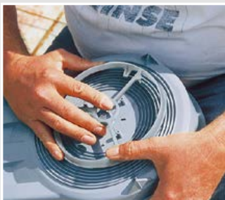
Klik de frontring op de behuizing.
