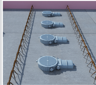
Erstelltes Fertigzeilelement mit integrierten HaloX-Gehäusen.
