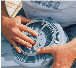
Frontring am Gehäuse einrasten.
