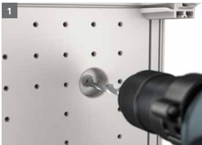
Schraublöcher (Montagelöcher) auf der Innenseite (oben links, rechts, unten links, rechts) mittels Bohrer öffnen.
