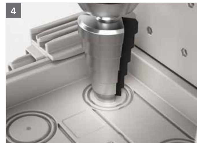
Ausbrechöffnung des Wandmoduls mittels Stufenbohrer auf gewünschte Größe bohren.
