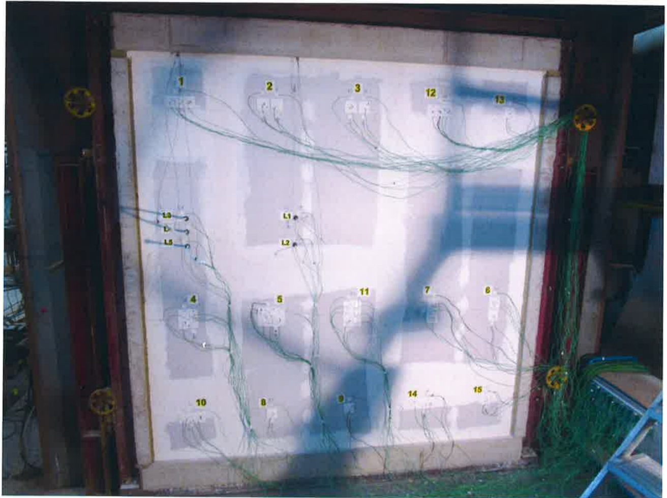
Probekörper vor dem Brandversuch am 15.07.2015 Luftseite
