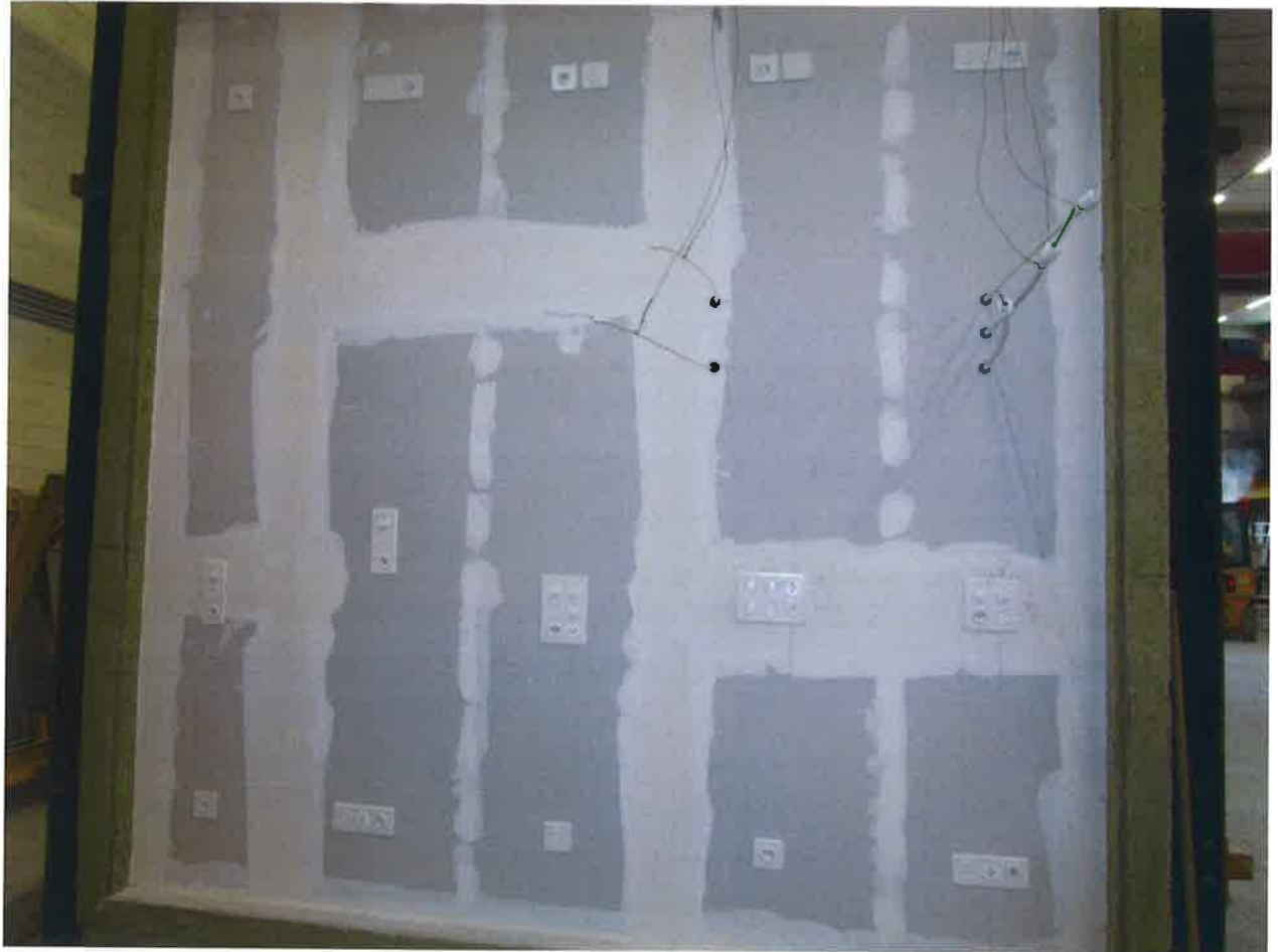
Probekörper vor dem Brandversuch am 15.07.2015 Feuerseite
