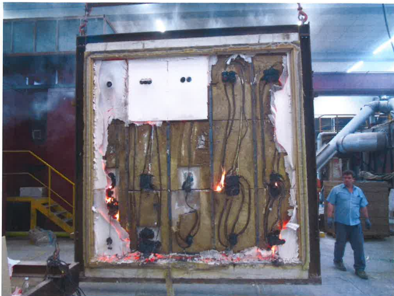
Probekörper nach dem Brandversuch von 95 Minuten Dauer Feuerseite
