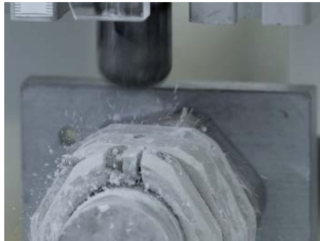
Schlagprüfung / Résistance aux chocs
