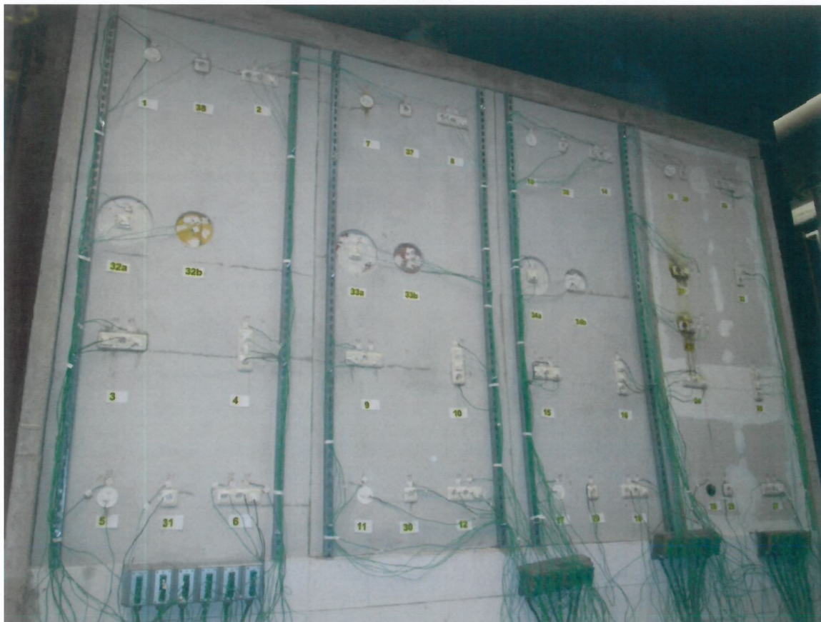
Probekörper nach dem Brandversuch von 125 Minuten Dauer Luftseite
