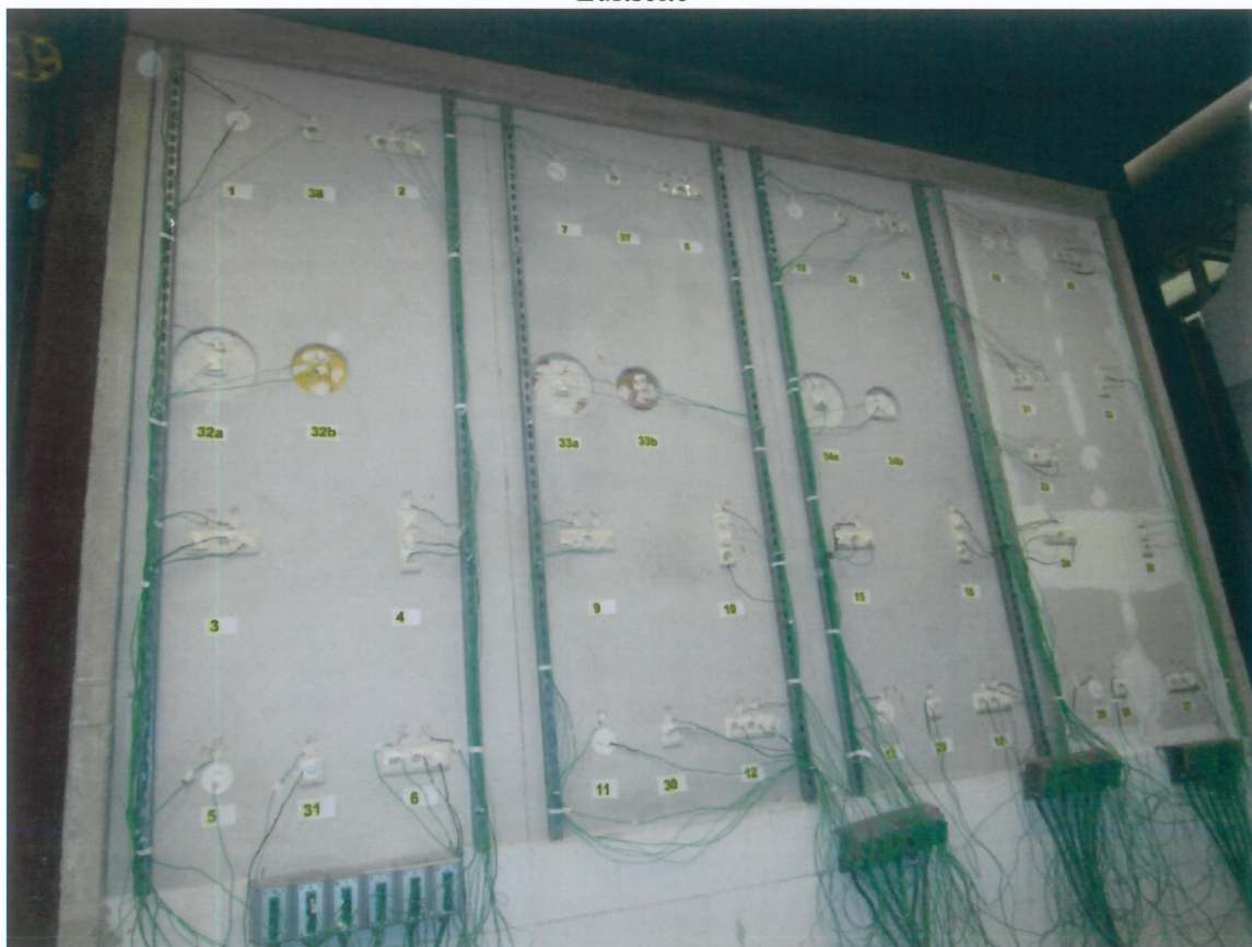
Probekörper vor dem Brandversuch am 24.11.2015 Luftseite
