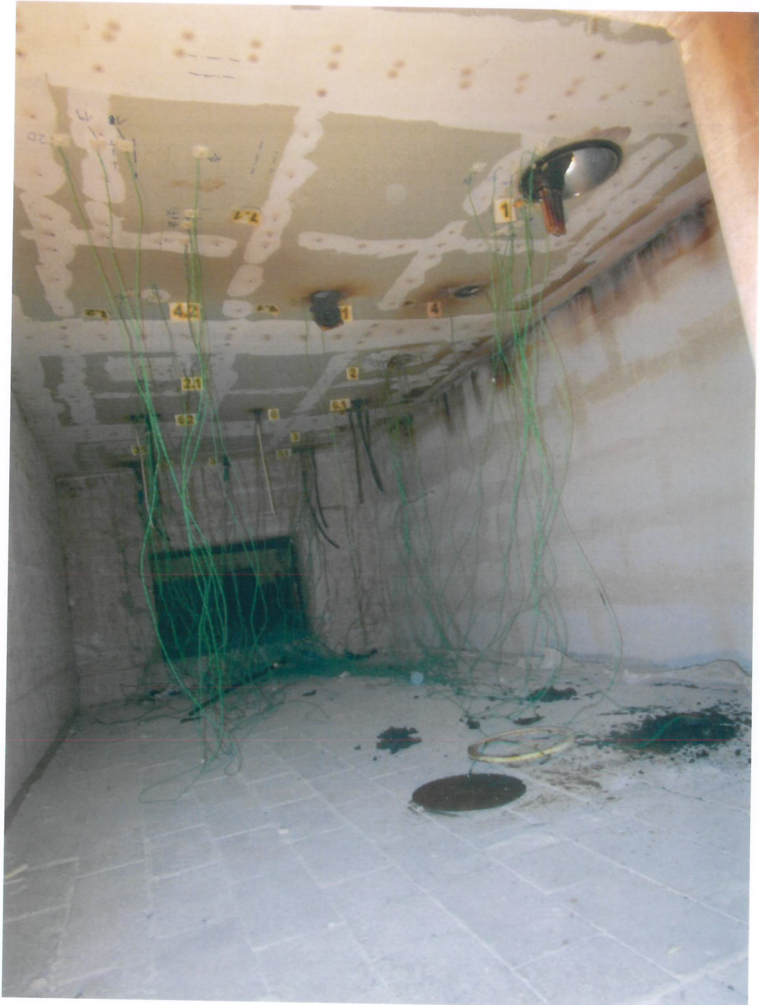
Probekörper nach dem Brandversuch von 35 Minuten Dauer Ansicht Luftseite
