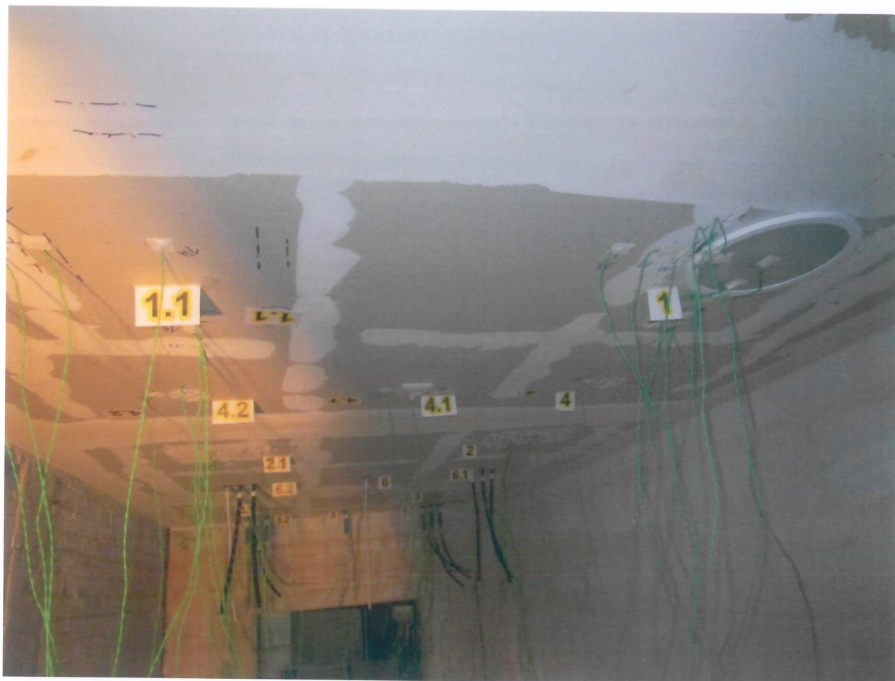
Probekörper vor dem Brandversuch am 01.07.2015 Ansicht Luftseite
