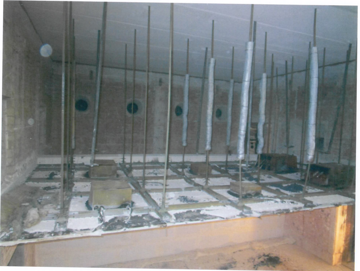
Probekörper nach dem Brandversuch von 35 Minuten Dauer Ansicht Feuerseite
