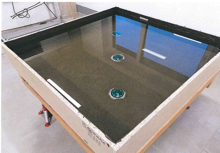
Bild 6: Befülltes Becken (Wasser H = 20 cm über 28 Tage)
