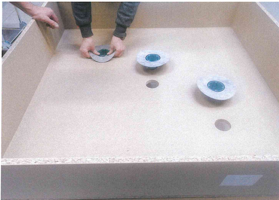
Bild 3: Einsetzen der Dosen in die gebohrten Öffnungen am Boden des Behälters und Fixieren durch Anziehen der Laschenschrauben
