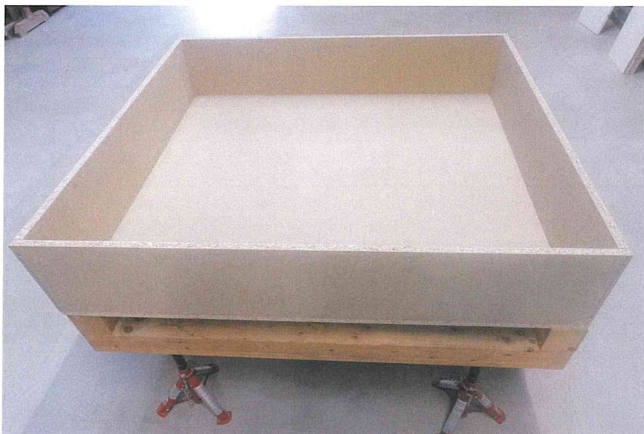
Bild 1: Vorbereitetes Becken aus Spanplatten
