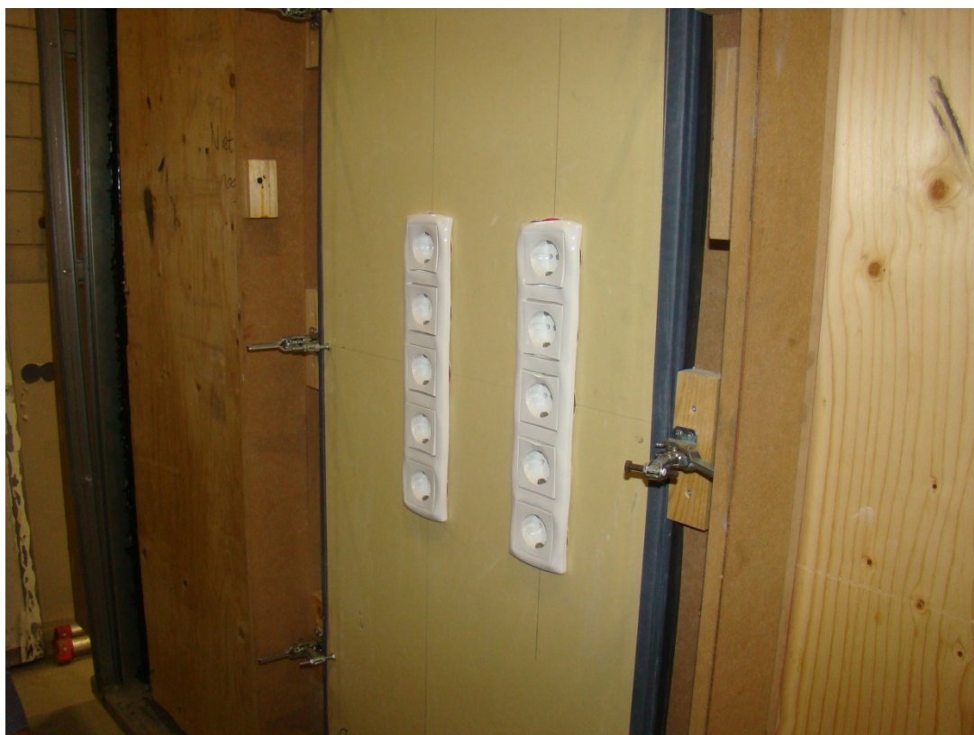
Foto B.5 S 200 test, verhitte paneel, vervorming van de contactdozen
