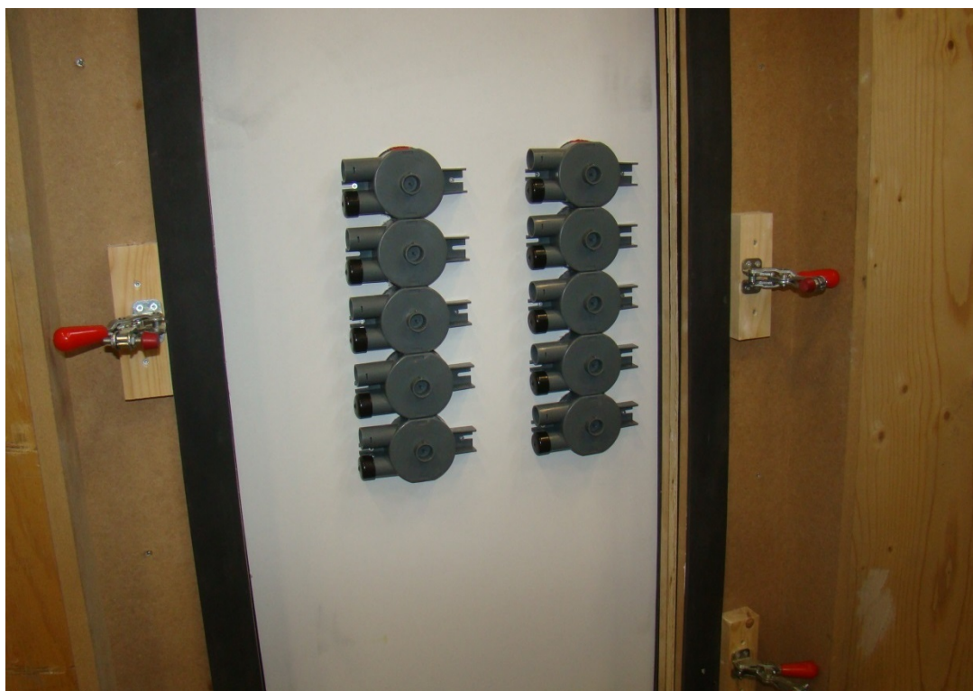
Foto B.2 S_a test, achterkant van het paneel gemonteerd aan de kant van de drukkamer, afgesloten HWD
