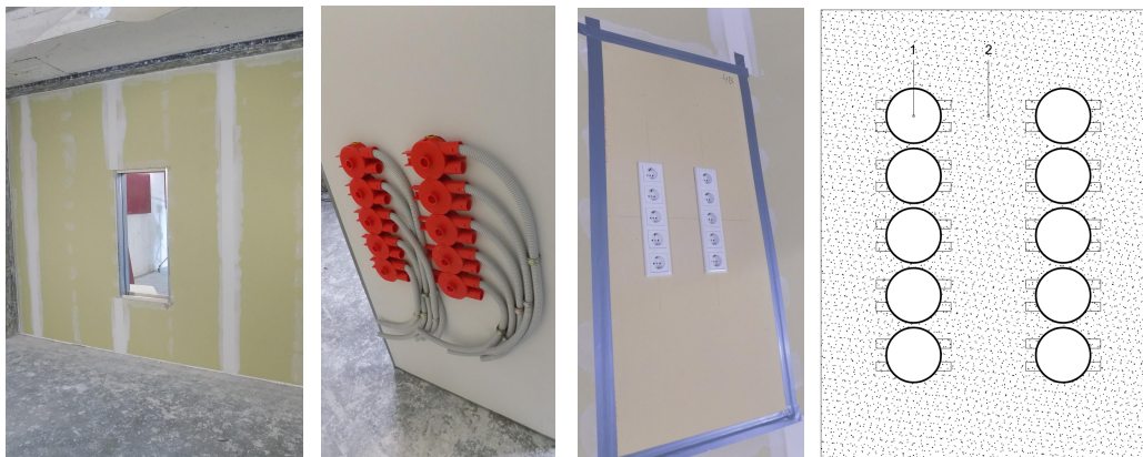
f2 afbeeldingen van de onderzochte wandcontactdozen aangebracht in de wandconstructie
