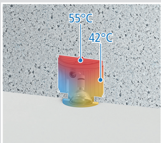
Temperaturprofil HV-Halogen-Leuchte max. 75 W (230 V).
