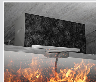
Die Dose füllt sich mit Dämmschichtbildner - das Gehäuse wird rauchdicht abgeschlossen.
