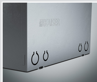
Zwei Einführungen für Kabel bis Ø 13.5 mm und zwei Einführungen für Rohre bis M25 pro Schmalseite.
