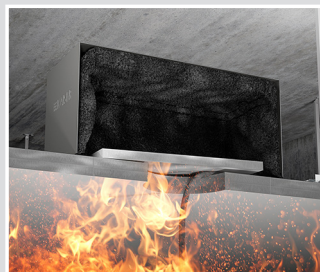
Die Gipsfaserplatte am Dosenboden löst sich und verschliesst die Einbauöffnung.
