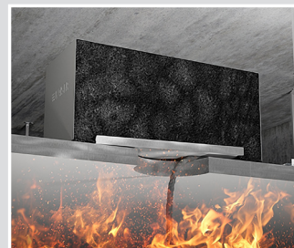
Le boîtier se remplit de mousse isolante et ainsi devient étanche à la fumée.
