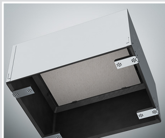
Intérieur de la boîte revêtu d'une couche écumante qui referme l'orifice d'installation en cas d'incendie.
