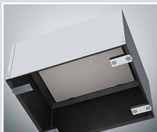
All'interno, la scatola è rivestita di uno strato che schiumeggia e richiude l'apertura d'installazione in caso d'incendio.
