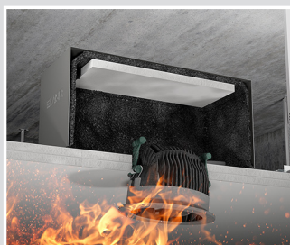
Lo strato isolante schiumeggia quando viene esposto al calore.
