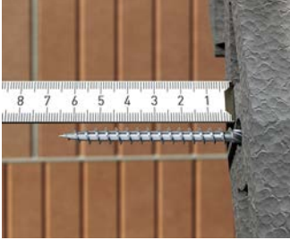
Der Dübel muss den Aufbau des Geräteträgers je nach Dübellänge um min. 30 mm überragen.
