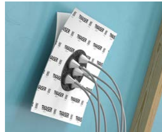
...Manschette aufkleben und gründlich von innen nach aussen auf dem Untergrund feststreichen.
