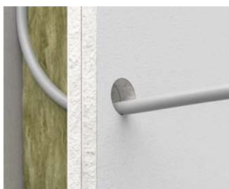
Praticare l'apertura di installazione da 20 mm con una fresa (p. es. fresa in metallo duro KAISER Art.-No. 1088-06) o una punta da trapano. Salvo errori e modifiche tecniche.
