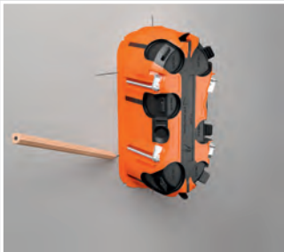
Utiliser les encoches horizontales de la boîte O-range ECON® pour déterminer l'entraxe de 71 mm
