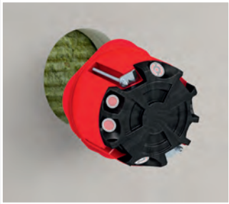
Jusqu'à 6 possibilités d'entrées pour les câbles gainés d'un diamètre extérieur compris entre 4 et 11,5 mm.
