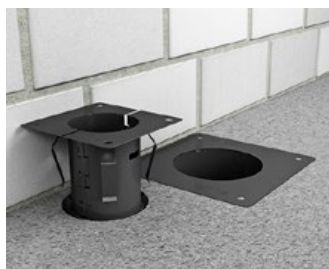
Introduire le manchon d'installation depuis le haut du plafond.
