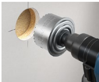
Créer un orifice d'encastrement exact de Ø 68 mm avec une fraise KAISER (p. ex. MULTI 2000 HM n° art. 1083-70) et la fraise de bordure.
