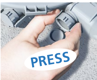
Entrée combinée sans outil pour tubes M20/M25 avec bûtte de tube – pas de raccourcissement ultérieur des tubes.
