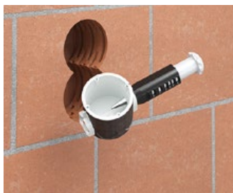
Le boîtier coupe-feu encastré offre 6 possibilités d'introduction pour des tuyaux jusqu'à M25 et des câbles de \varnothing 11,5 mm maximum.
