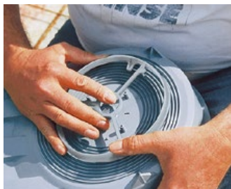
Enclencher la bague avant dans le boîtier.
