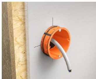
Les marquages au centre sur la première rangée de nervures de serrage devant le mur et les bords de centrage aident à positionner et à insérer la boîte avec précision et sans inclinaison.
