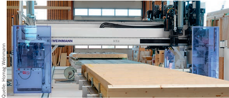
2 Wand- Fertigungslinie im Holzbau
